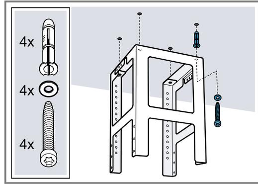
4. Faça quatro furos com 8 mm de Ø e 80 mm de profundidade para as fixações e introduza as buchas à face.
