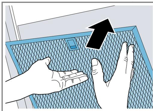
3. Se o filtro de gorduras tiver sido colocado incorretamente, pressione o bloqueio com cuidado para a frente, retire o filtro de gorduras e coloque-o corretamente.
