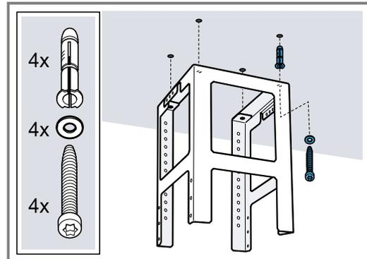
4. Taladrar cuatro agujeros con un diámetro de 8 mm y una profundidad de perforación de 80 mm para las fijaciones y seguidamente introducir los tacos de tal manera que queden al ras.
