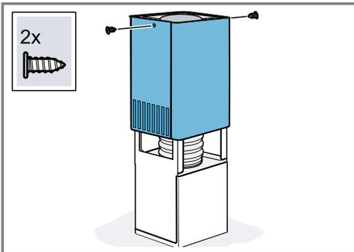
5. Colocar ambas partes del revestimiento inferior de la chimenea sobre el aparato y acoplarlas.
