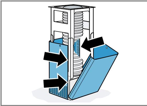
**Nota:** Las ranuras del revestimiento de la chimenea deben colocarse hacia abajo.
