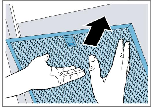
3. Si el filtro antigrasa no se ha colocado correctamente, presionar con cuidado el bloqueo hacia delante, retirar el filtro antigrasa y colocarlo correctamente.
