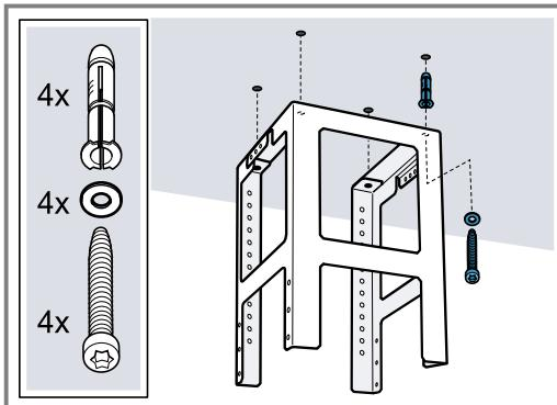
4. Izvrtajte štiri luknje s premerom 8 mm in globino 80 mm za pritrdila in vstavite vložke do konca v steno.
