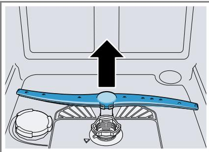
3. Unter fließendem Wasser die Ausstritsdüsen der Sprüharme auf Verstopfungen prüfen und gegebenenfalls Fremdkörper entfernen.
