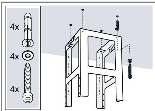
4. Izbušite četiri otvora za pričvršćivanje prečnika Ø 8 mm i dubine 80 mm i ravno utisnite tiplove.
