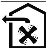
Zrak se ne smije odvoditi u dimnjak, koji se koristi za ispušne plinove uređaja, koji izgaraju plin ili druga goriva (to ne vrijedi za uređaje s optočnim zrakom).
