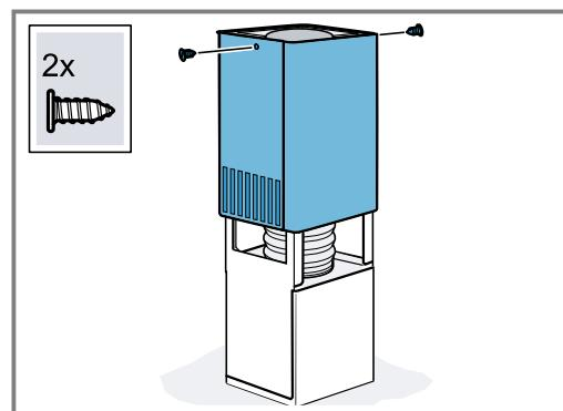
5. Stavite oba dijela donje obloge dimnjaka na uređaj i zajedno utaknite.
