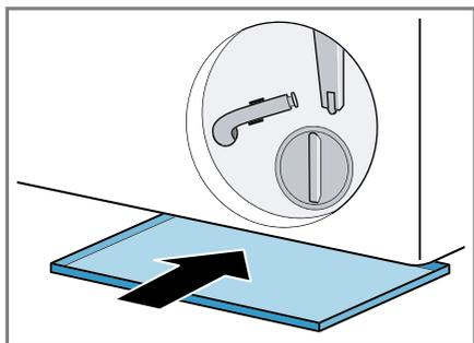
6. Extraer el tubo de drenaje de la sujeción.
