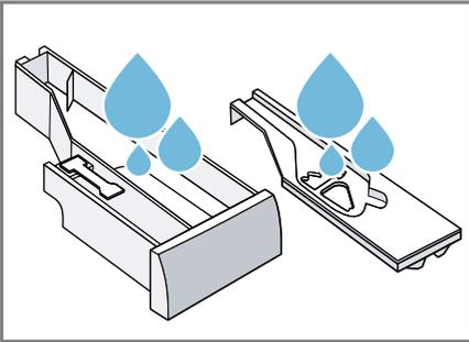
9. Secar y colocar el compartimento para detergente, la tapa y la unidad de bomba.
