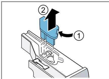
5. Desencajar la tapa del compartimento para detergente por la parte trasera y extraerlo.
