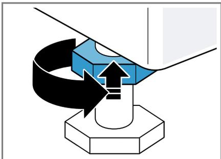
Sujetar a tal efecto las patas del aparato sin modificar su altura.
