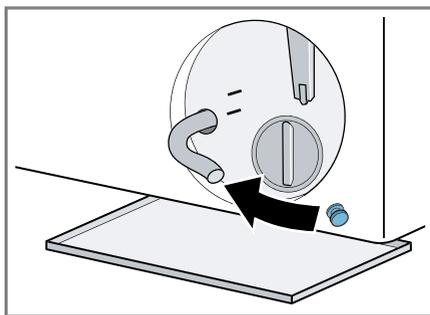
9. Sujetar el tubo de drenaje a la sujeción.
