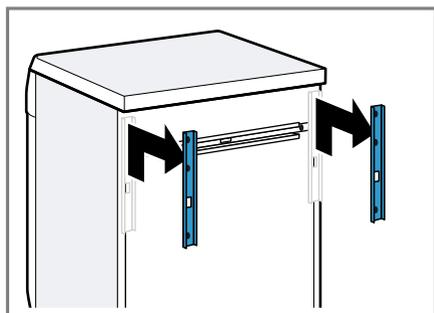
3. Soltar y retirar los tornillos de los travesaños de transporte horizontales con un destornillador T20.
