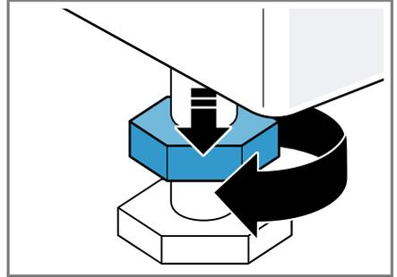
2. Girar las patas del aparato para nivelarlo. Comprobar la nivelación con un nivelador de agua.
