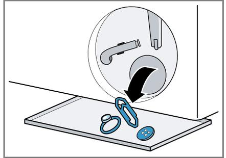
La tapa de la bomba consta de dos componentes que se pueden desmontar para su limpieza.
