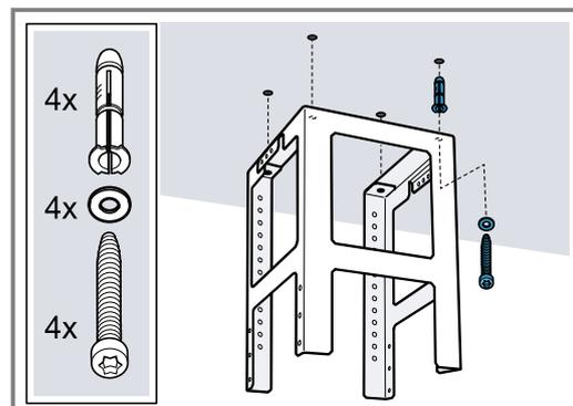
4. Vier Löcher mit  $\varnothing$  8 mm und Bohrtiefe 80 mm für die Befestigungen bohren und die Dübel bündig eindrücken.
