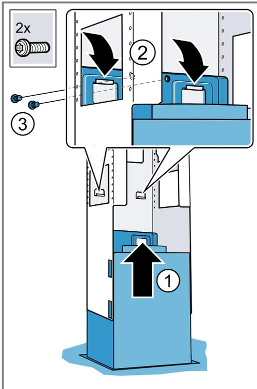
3. Die Sicherungsbügel einhängen und festschrauben.
