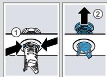
5. Unter fließendem Wasser die Siebelemente reinigen.
