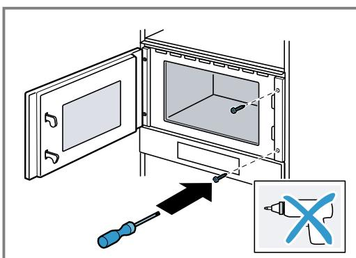
**5.** Die Bohrungen für die Verschraubung auf der Seite der Scharniere am Möbel vorbohren.
