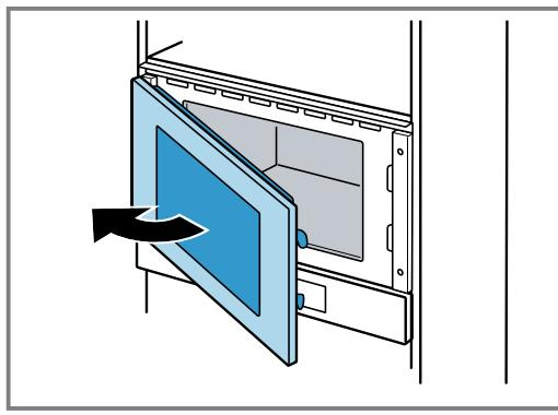
4. Прикрутіть пристрій до меблів з протилежного боку від петель.
