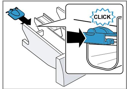
4. Die Waschmittelschublade einsetzen.
