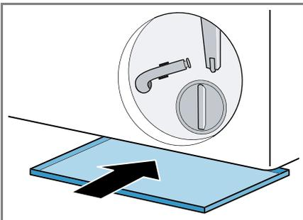
6. Den Entleerungsschlauch aus der Halterung nehmen.
