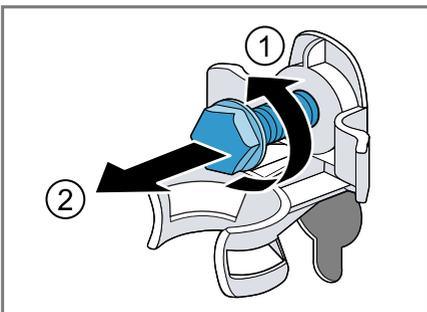
3. Die Netzanschlussleitung aus der Halterung ziehen.
