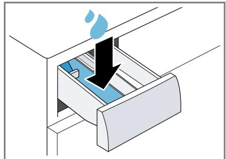
5. Pulvervollwaschmittel in die Kammer II einfüllen.
