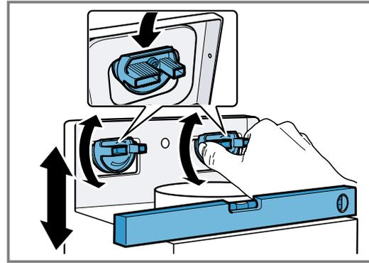
Bei Bedarf das Gerät nach rechts oder links verschieben.
