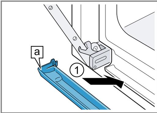
2. Engager les crochets **a** du bac de condensation à gauche et à droite dans l'espace ①.
