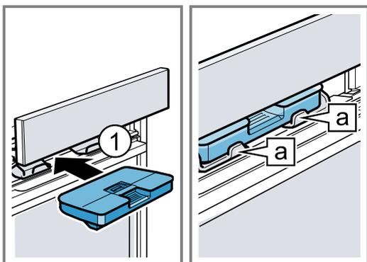
7. Poussez lentement le bandeau de commande vers le bas, puis enfoncez-le vers l'arrière jusqu'à ce qu'il soit entièrement fermé.
