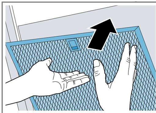
3. Se il filtro antigrasso è stato inserito in modo errato, premere con cautela verso la parte anteriore del dispositivo di bloccaggio, rimuovere il filtro antigrasso e innestarlo correttamente.
