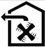
空氣不得導入使用煤氣或其他燃料的電器排出廢氣所用的煙管罩內（不適用於空氣循環裝置）。
