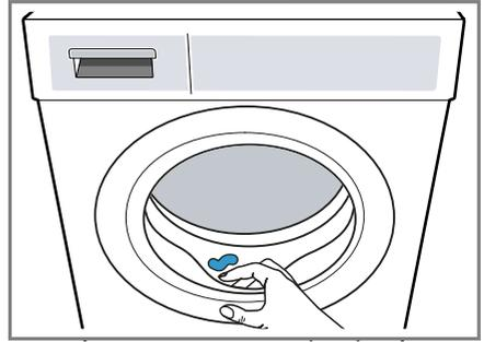
4. Dejar el compartimento para detergente y la puerta de aparato abiertos para que pueda secarse el agua residual.
