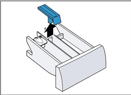
4. Limpiar y secar el compartimento para detergente y la pieza insertada con agua y un cepillo.
