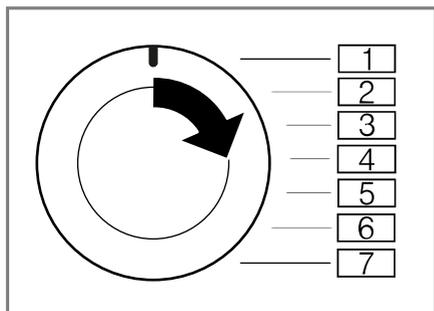
2. Pulsar **Centrif.** y colocar simultáneamente el selector de programas en la posición 2.
