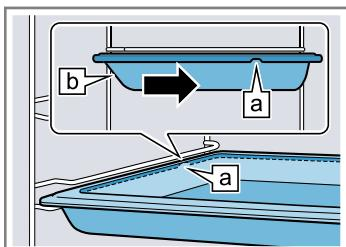
3. Da biste na visine za ubacivanje sa šinama za izvlačenje stavili pribor, izvucite šine za izvlačenje.
