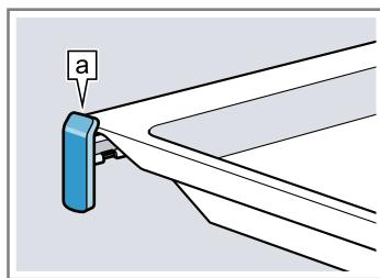
**Napomena:** Šine za izvlačenje uležu u ležište kada se potpuno izvuku. Šine za izvlačenje neznatnim pritiskom gurnite nazad u pećnicu.
