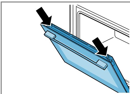
3. Vrata uređaja potpuno otvorite i pritisnite u smeru uređaja.
