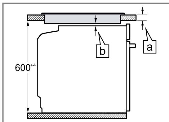
Zbog neophodnog minimalnog odstojanja [b], minimalna debљina radne ploče mora biti [a].
