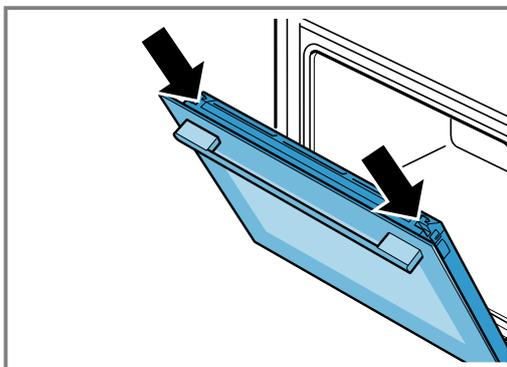
3. Die Gerätetür ganz öffnen und in Richtung Gerät drücken.
