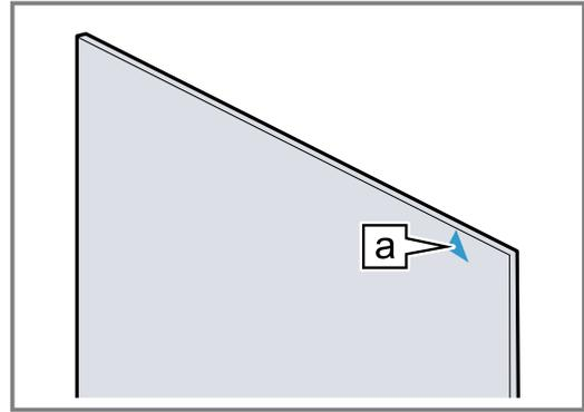
2. Die Zwischenscheibe unten in die Halterung [a] einsetzen ① und oben andrücken und festhalten.
