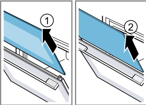
8. Die Gerätetür öffnen und Türdichtung abnehmen.
