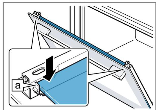
5. Die Gerätetür öffnen und Türdichtung einhängen.
