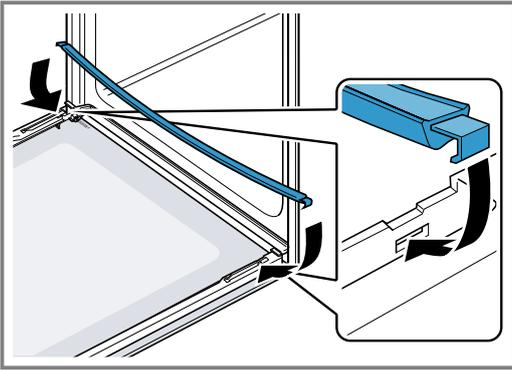
6. **Hinweis:** Achten sie beim Einschieben der Scheibe, dass die glänzende Seite der Scheibe außen ist und der Ausschnitt links und rechts oben ist. Die Innenscheibe in die linke und rechte Halterung **a** schieben.
