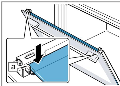
5. Die Gerätetür öffnen und Türdichtung einhängen.
