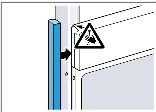
2. Aluprofile vorbohren, um eine Schraubverbindung herzustellen.
