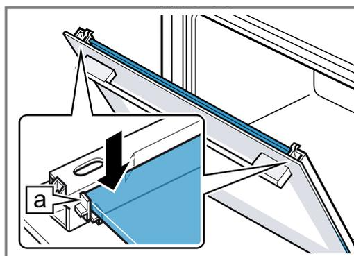
5. **Hinweis:** Achten sie beim Einschieben der Scheibe, dass die glänzende Seite der Scheibe außen ist und der Ausschnitt links und rechts oben ist. Die Innenscheibe in die linke und rechte Halterung [a] schieben.
