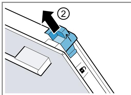
6. Retire o vidro interior obliquamente para cima e pouse-o sobre uma superfície plana.
