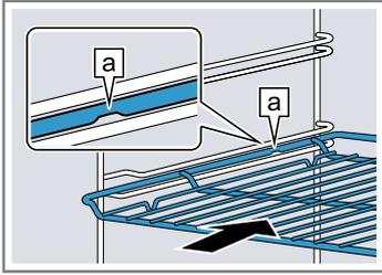
Blech z. B. Universalpfanne oder Backblech Das Blech mit der Abschrägung
