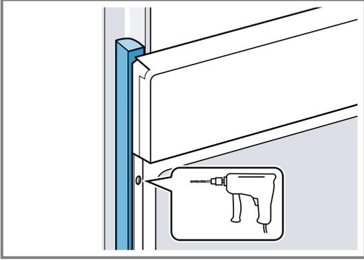
4. Das Gerät mit adäquater Schraube befestigen.
