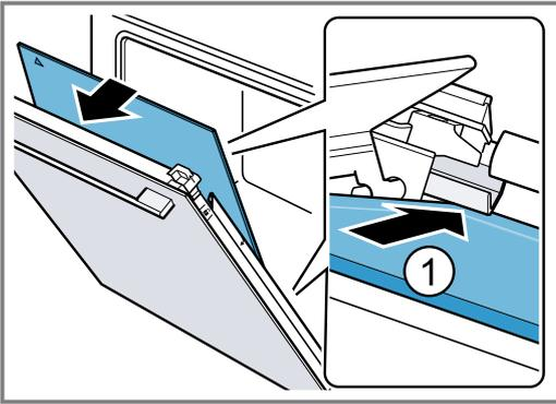
2. **Hinweis:** Die Zwischenscheibe positioniert sich automatisch durch die Drehbewegung der Abstandshalterung. Die zweite Zwischenscheibe in die mittlere Halterung einschieben ① und oben anlegen.
