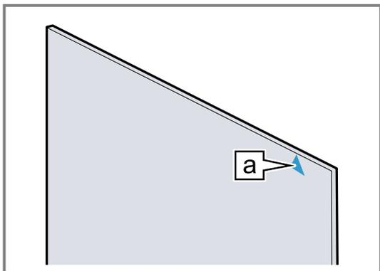
2. Inserire il pannello intermedio sotto il fermo **a** e **1** premerlo in alto e fissarlo.
