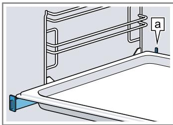
**Nota:** Spingere indietro con una leggera pressione le guide di estrazione nel vano cottura.
