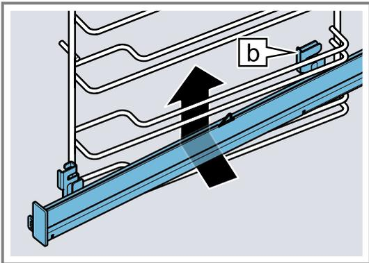
2. Die Schiene längs zu den Führungsstäben nach hinten führen und beide Halterungen jeweils auf den unteren Stab aufschieben. Dabei mit der hinteren Halterung
