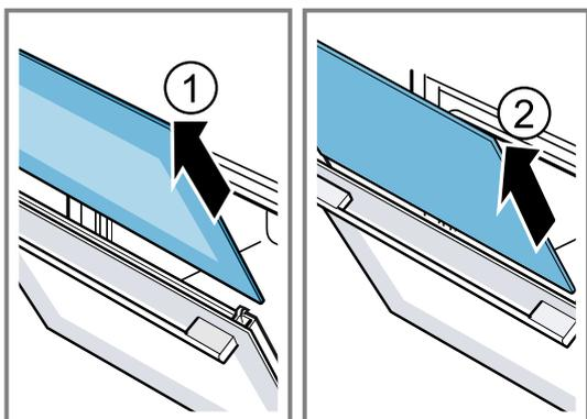
8. Die Gerätetür öffnen und Türdichtung abnehmen.
