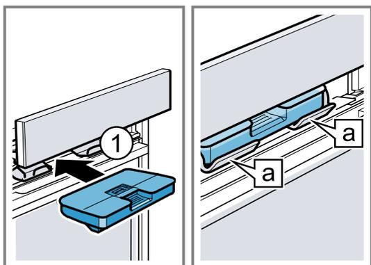
9. Die Bedienblende langsam nach unten schieben, dann nach hinten drücken, bis die Bedienblende vollständig geschlossen ist.
