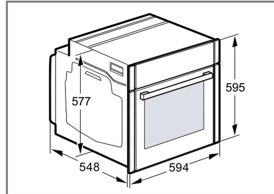
**31.3 Einbau unter einer Arbeitsplatte**
