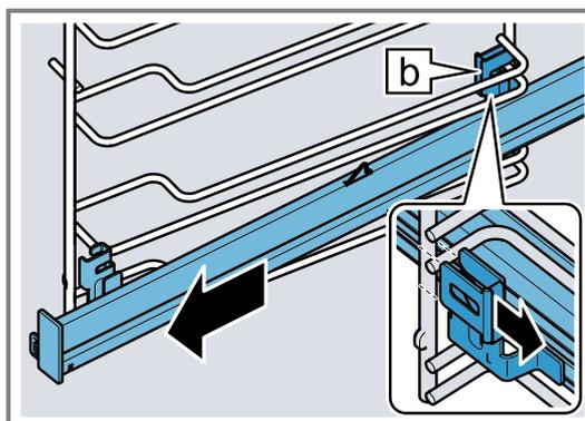
4. Die Auszugsschiene entfernen.
