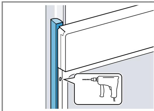
4. Das Gerät mit adäquater Schraube befestigen.
