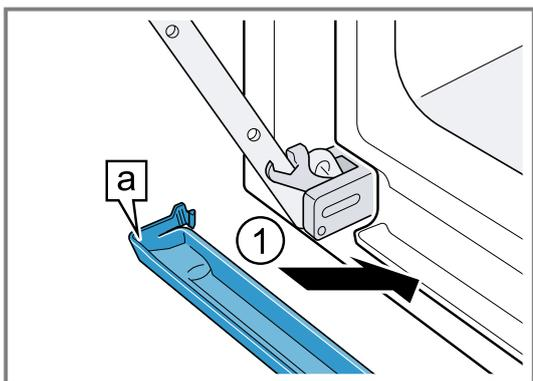
2. Die Haken
