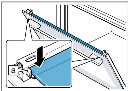
5. Die Gerätetür öffnen und Türdichtung einhängen.
