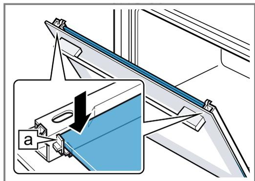
5. Die Gerätetür öffnen und Türdichtung einhängen.
