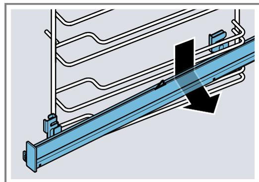
5. Die Auszugsschiene reinigen.
