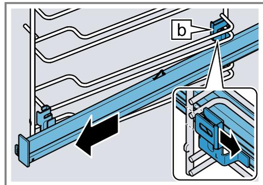
4. Die Auszugsschiene entfernen.
