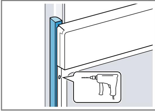
4. Fixez l'appareil avec une vis adéquate.
