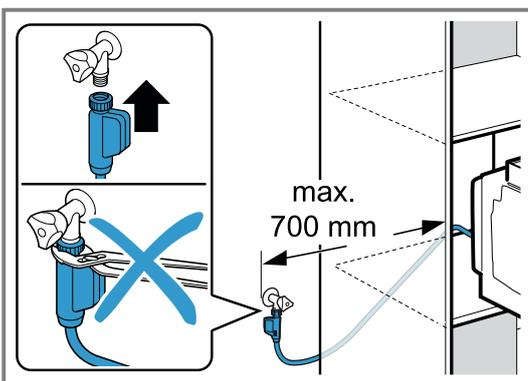
Serrez l'écrou de serrage en plastique uniquement à la main.
