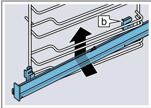
2. Guidez le rail dans le sens de la longueur vers les barres de guidage à l'arrière et poussez les deux supports à chaque fois sur la barre inférieure. Saisissez la barre verticale avec le support arrière
