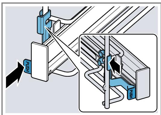
2. Maintenez enfoncé **PUSH** ① et faites pivoter le rail vers l'extérieur ②, jusqu'à ce que le support avant ③ soit accroché.
