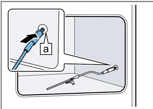
5. Das Röhrchen am Ende des Anschluss Schlauches in den Behälter stellen. Bei Bedarf das Röhrchen mit dem Klipp
