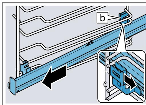
4. Die Auszugsschiene entfernen.
