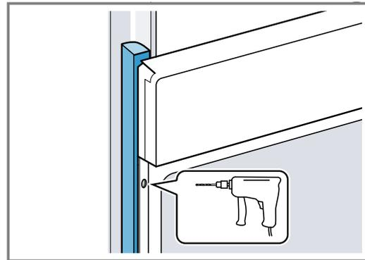
3. Gerät mit adäquater Schraube befestigen.
