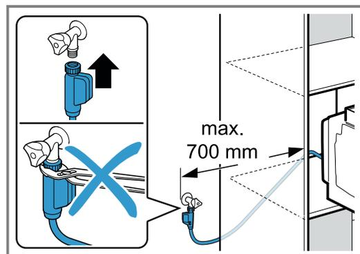
Kunststoff-Überwurfmutter nur von Hand festziehen. Zulaufschlauch nicht auf Zug belasten, einklemmen, quetschen, oder zu eng biegen. Bei nicht ausreichender Schlauchlänge, kann eine Schlauchverlängerung verwendet werden. Eine 2 m lange Schlauchverlängerung ist beim Kundendienst erhältlich.
