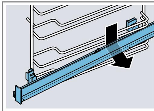
5. Die Auszugsschiene reinigen.
