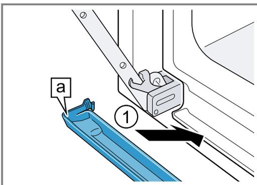
2. Die Haken **a** der Kondensatwanne links und rechts in die Spalte einrasten **1**.
