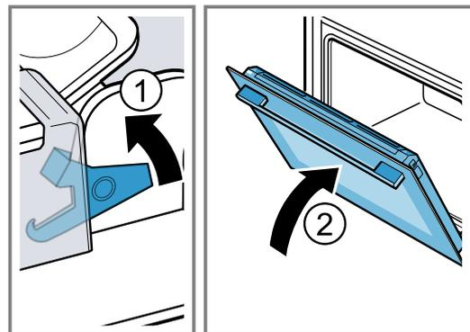
4. Die Türabdeckung links und rechts von außen drücken **1**, bis sie ausrastet.
