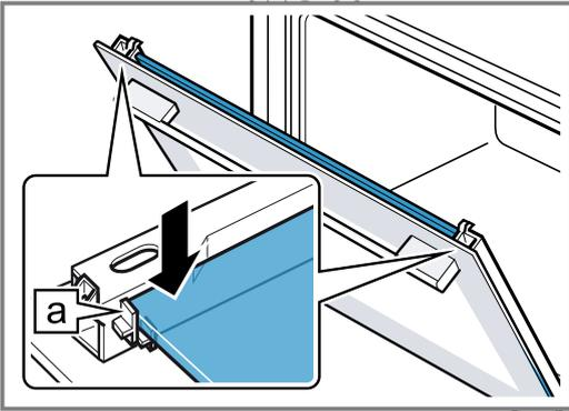
5. Die Gerätetür öffnen und Türdichtung einhängen.
