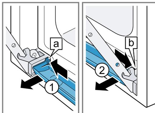
3. Die Kondensatwanne leicht nach vorne kippen bis sich die unteren Halteklappen lösen.
