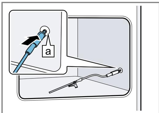
6. Das Röhrchen am Ende des Anschluss Schlauches so in den Behälter stellen, dass die komplette Flüssigkeit ins Gerät gepumpt werden kann. Bei Bedarf das Röhrchen mit dem Klipp
