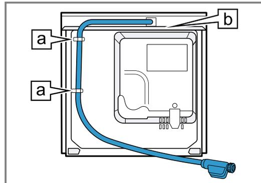
5. Zulaufschlauch mit Anschlusswinkel am Hausanschluss montieren.
