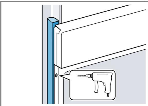
3. Gerät mit adäquater Schraube befestigen.
