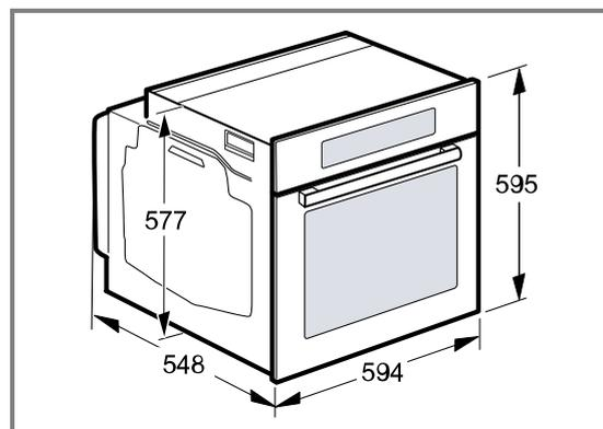
**29.3 Einbau unter einer Arbeitsplatte**
