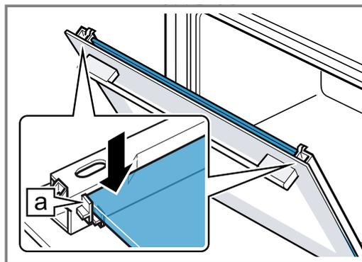
5. Die Gerätetür öffnen und Türdichtung einhängen.
