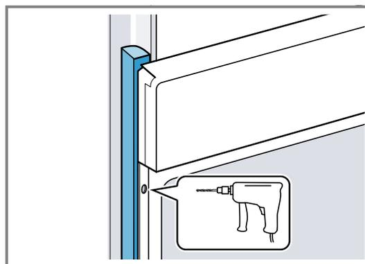
4. Das Gerät mit adäquater Schraube befestigen.
