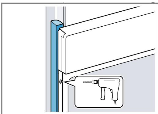
3. Fixer l'appareil avec une vis adéquate.
