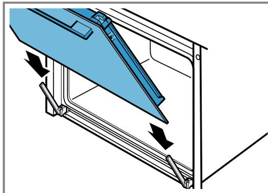
1. Poussez la porte de l'appareil jusqu'en butée à l'aide des deux mains.
