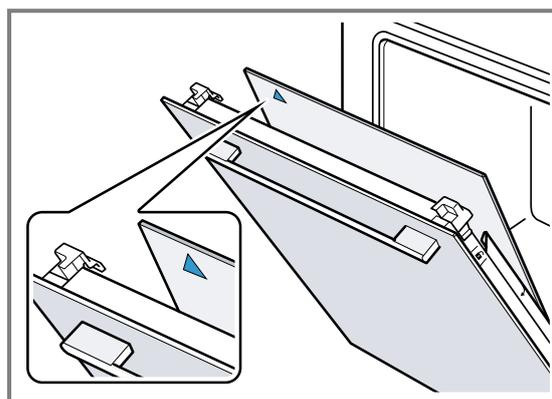
1. Die erste Zwischenscheibe in die unterste Halterung einschieben ① und oben anlegen.
