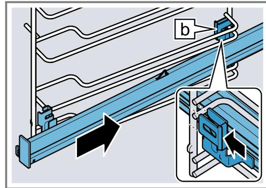
3. **PUSH** gedrückt halten ① und die Auszugsschiene nach innen schwenken ②, bis die Halterung
