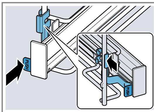
2. **PUSH** gedrückt halten ① und die Schiene nach außen schwenken ②, bis die vordere Halterung **a** ausgehängt ist.
