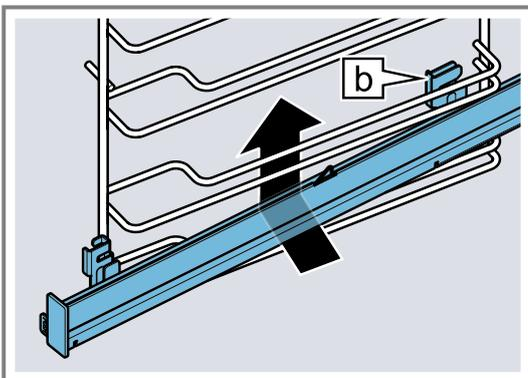
2. Die Schiene längs zu den Führungsstäben nach hinten führen und beide Halterungen jeweils auf den unteren Stab aufschieben. Dabei mit der hinteren Halterung
