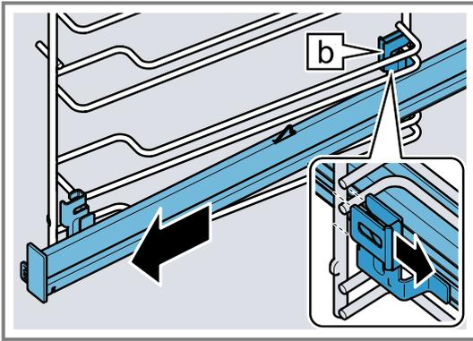
4. Die Auszugsschiene entfernen.
