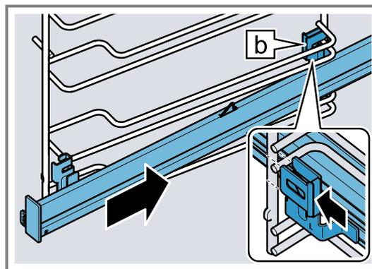
3. Maintenez enfoncé **PUSH**  et faites pivoter le rail télescopique vers l'intérieur , jusqu'à ce que le support  soit accroché dans la barre inférieure.
