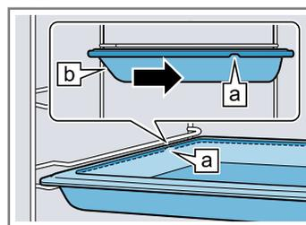
Posez l'accessoire sur les rails télescopiques insérés.
