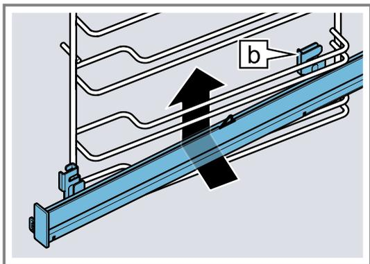
2. Guidez le rail dans le sens de la longueur vers les barres de guidage à l'arrière et poussez les deux sup-
