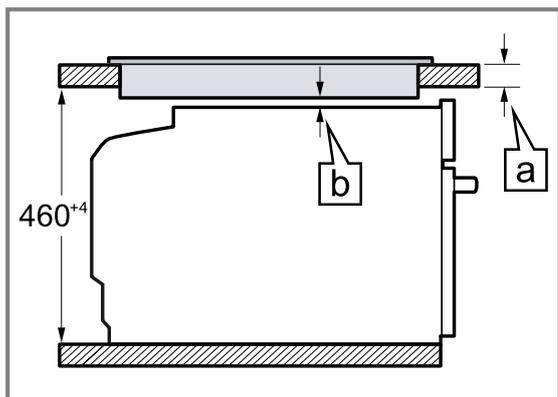
En raison de la distance minimale nécessaire  $\boxed{b}$  l'épaisseur minimale du plan de travail qui en découle est  $\boxed{a}$ .
