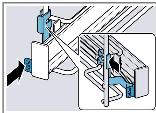
2. Maintenez enfoncé **PUSH** ① et faites pivoter le rail vers l'extérieur ②, jusqu'à ce que le support avant soit accroché.
