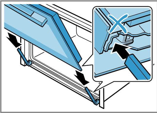
2. Appuyez sur le recouvrement de la porte à l'aide des deux mains en haut à gauche et à droite pour vérifier si la porte de l'appareil est bien enfoncée jusqu'en butée.
