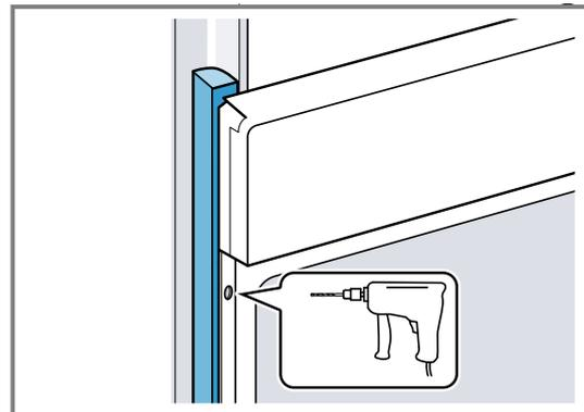
4. Das Gerät mit adäquater Schraube befestigen.
