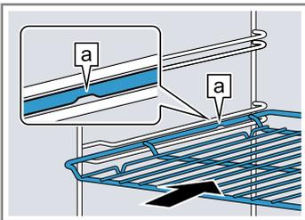
Blech z. B. Universalpfanne oder Backblech Das Blech mit der Abschrägung
