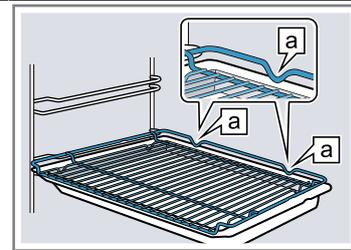
Rost Den Rost mit der offenen Seite zur Gerätetür und der Krümmung
