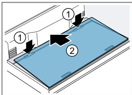
2. Saisissez les deux évidements à l'avant du fond du compartiment réfrigération ①, soulevez la plaque en verre du compartiment réfrigération et retirez-la ②.
