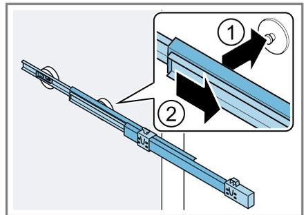
2. Insérez le rail de sortie au niveau du boulon arrière ① et faites glisser le dispositif de verrouillage vers l'arrière ②.
