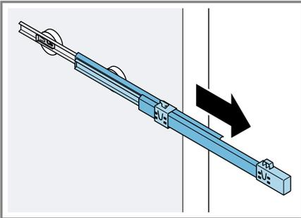
2. Poussez le dispositif de verrouillage dans le sens de la flèche ① et relâchez-le par le boulon arrière ②.
