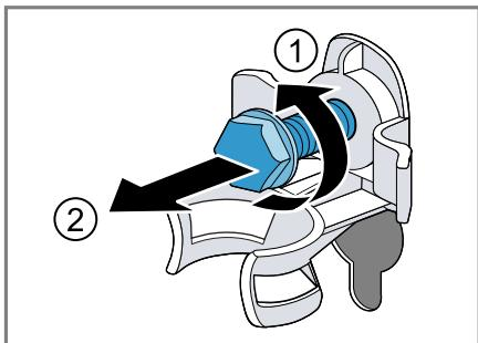
3. Die Netzanschlussleitung aus der Halterung ziehen.
