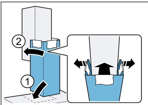
7. Die untere Kaminverblendung am unteren Haltewinkel einklipsen. Darauf achten, dass die Anschlusskabel nicht eingeklemmt sind.
