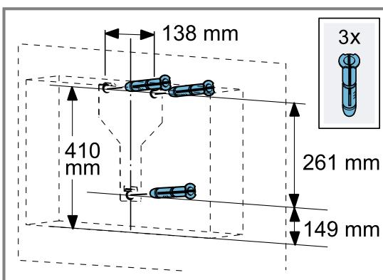
Varijanta A: vertikalni aspirator bez oplate dimnjaka
