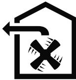
Vazduh ne sme da se odvodi u dimnjak, koji se koristi za odvodne gasove iz uređaja, koji sagorevaju gas ili druga goriva (ne važi za uređaje sa cirkulacijom vazduha).
