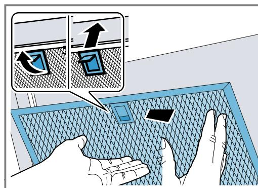
3. Ukoliko ste pogrešno postavili filter za masnoću, blokadu pažljivo pritisnite ka napred, izvadite filter za masnoću i postavite ga pravilno.
