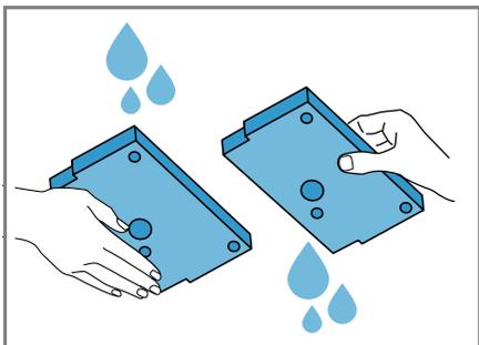
Pode remover fortes sujidades cuidadosamente com um aspirador. Não limpe a esteira filtrante com produtos de limpeza.
