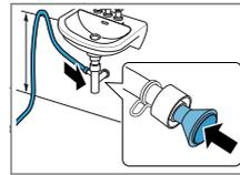
Fixe o ponto de união com uma braçadeira da mangueira (12-22 mm). Fixe o mangueira de escoamento de água com uma guia de mangueira a uma altura mínima de 80 cm e máxima de 100 cm.
