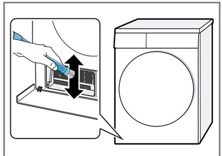
Assegure-se de aspirar as lamelas de cima para baixo e de não as deformar nem danificar.
