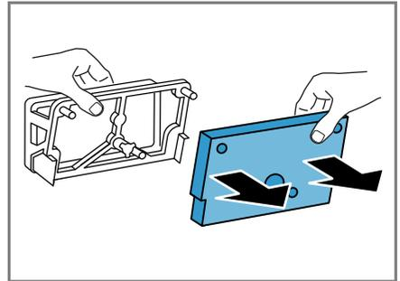
Assegure-se de não deformar nem danificar a esteira filtrante.
