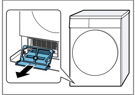
5. Lavar o encaixe em água corrente e secar.
