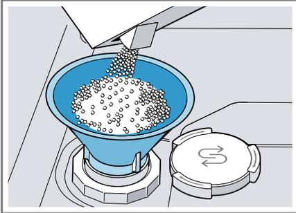
Den Vorratsbehälter komplett mit Spezsalsalz füllen. Das Wasser im Vorratsbehälter wird verdrängt und läuft ab.
