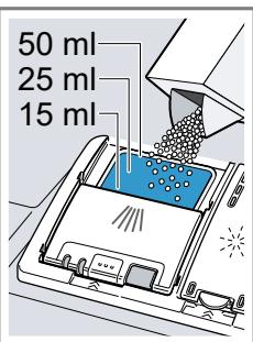
Wenn Sie Tabs verwenden, genügt eine Tablette. Tabs quer einlegen. Wenn Sie Pulverreiniger oder Flüssigreiniger verwenden, beachten Sie die Dosierungshinweise des Herstellers und die Dosierungsteilung der Reinigerkammer. Bei normaler Verschmutzung genügen 20 ml – 25 ml Reiniger. Bei wenig verschmutztem Geschirr genügt eine etwas geringere als die angegebene Reinermenge.
