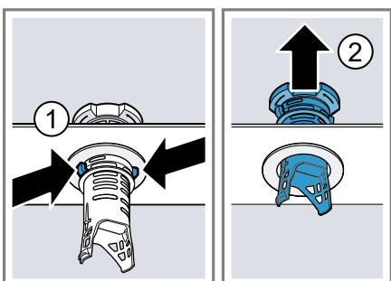
5. Unter fließendem Wasser die Siebelemente reinigen.
