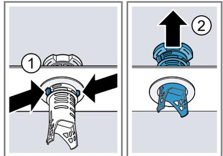
5. Unter fließendem Wasser die Siebelemente reinigen.
