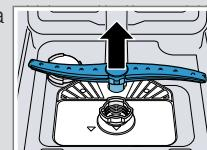
3. Verifique a existência de entupimentos nos orifícios de saída dos braços aspersores sob água corrente e, se necessário, remova os corpos estranhos.
