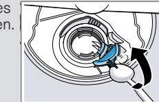
5. Die Pumpenabdeckung schräg nach innen anheben und entnehmen.
