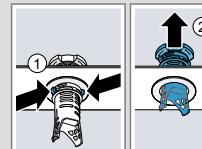
5. Unter fließendem Wasser die Siebelemente reinigen.
